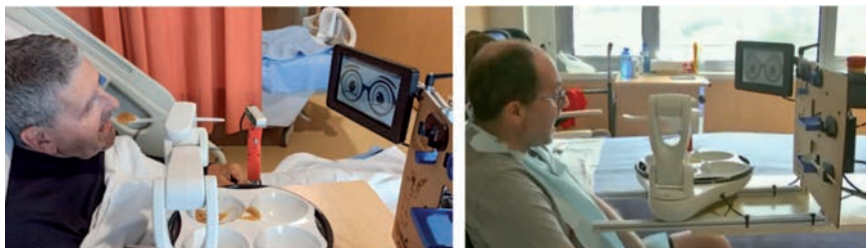
Figura 30. Programa piloto llevado a cabo en el Parque sociosanitario Pere Virgili de Barcelona para testear un brazo robótico sensorizado para dar de comer. A sugerencia del personal sanitario y de algunos pacientes, se añadió al brazo portátil un intercambiador de elementos (cuchara, tenedor, tubo de bebida y servilleta) para que, con una interfaz muy sencilla, el paciente con movilidad reducida que lo desee pueda comer de forma autónoma.
