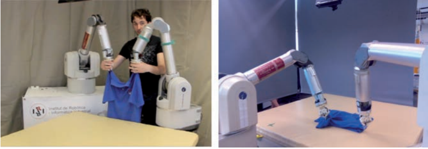
Figura 26. Escenario experimental de la tarea de enseñar a un robot bimanual a doblar prendas, en este caso un polo, mediante una demostración inicial (imagen de la izquierda) seguida de aprendizaje autónomo por reforzamiento (imagen de la derecha).
