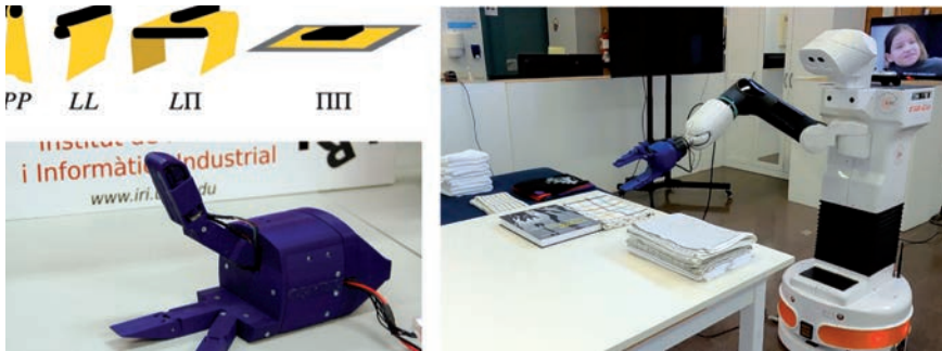
Figura 21. Mano robótica que combina distintos tipos de agarres de la taxonomía propuesta en [56], permitiendo así realizar múltiples funciones en la manipulación de textiles [57].
