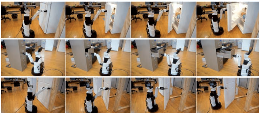
Figura 9. El robot HSR abre con éxito distintos tipos de puertas, sin conocer a priori su modelo cinemático [19].
