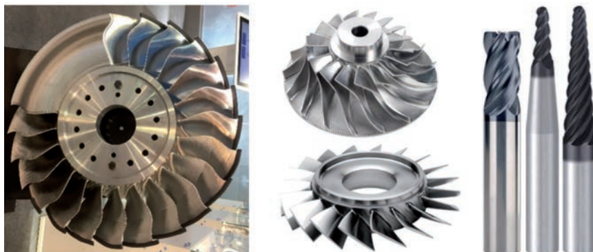
Figura 78: Izda. Rotores integrales diámetro (0,7 m). Ctr) Impeller y blisk (blade on disk) en Ti6Al4V producidos en 2015 en la UPV/EHU. Dcha. Fresas para estas operaciones.
