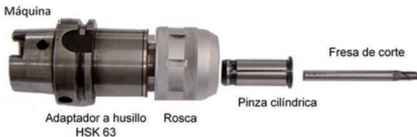
Figura 13: Portaherramientas o “cono”, en este caso HSK 63 de gran apriete con pinza cilíndrica.
