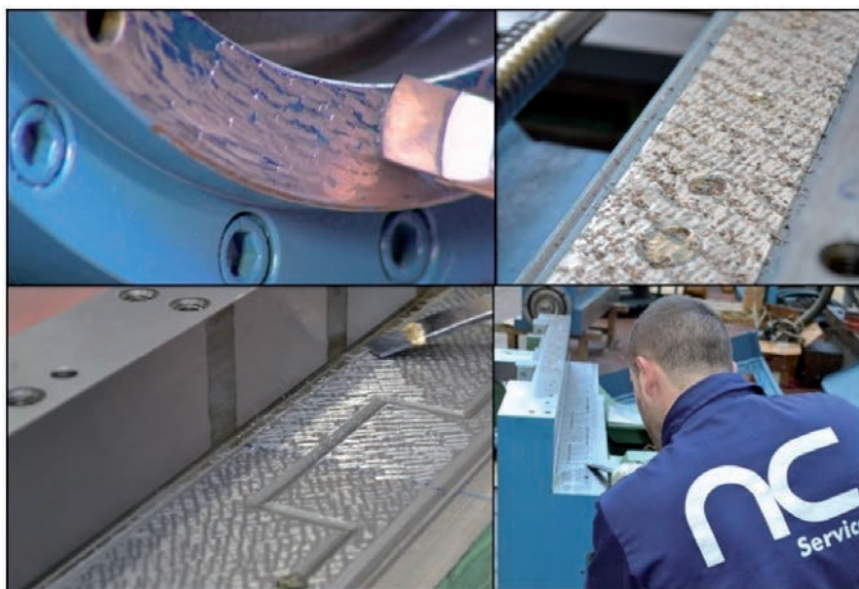
Figura 32: Rasquetado de guías en la empresa Nicolás Correa.
