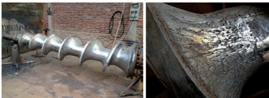
Figura 76: Izda. Tornillo sinfín de grandes dimensiones que debe repararse tras la zafra de la caña de azúcar. Dcha.) Detalle del desgaste tipo y magnitud de deterioro.
