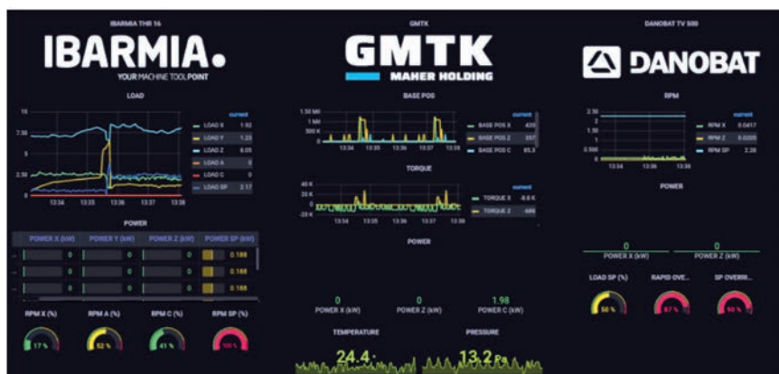
Figura 83: La monitorización es clave para rebajar el consumo, al conocer los procesos. Pantalla en el centro de control del CFAA graficando datos de tres de las máquinas.
