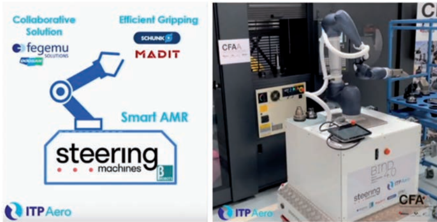
Figura 71: Solución de AMV y robot colaborativo en el CFAA, para carga y descarga de herramienta en máquinas fresadoras y tornos verticales.
