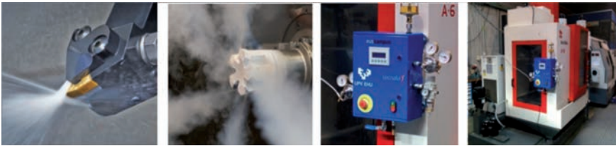
Figura 82: Sistema BeCOLD® para lubricación combinada con CO 2 criogénico e instalación en una fresadora.
