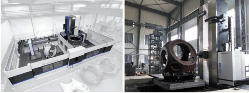
Figura 79: Izda. Fresadora Soraluze® en mecanizado de bujes de aerogeneradores. Dcha. Fresadora de N.Correa®.
