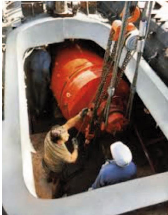
Extraña fotografía en la que se observa la extracción del núcleo en un submarino francés a través de la escotilla logística. (Fuente: <https://uploads.fas.org>)
