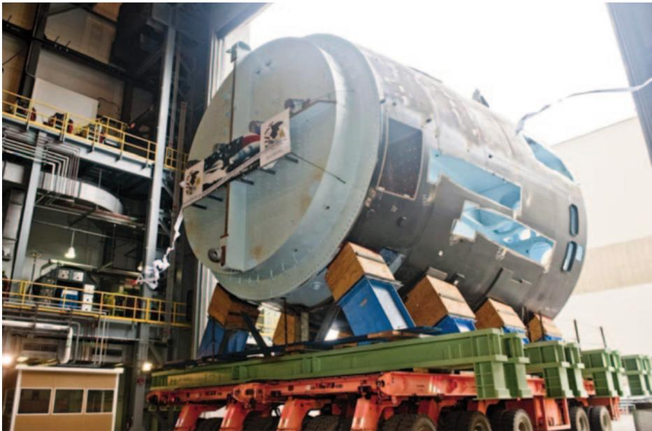
Sección sellada de un reactor a su llegada a la grada de construcción.
