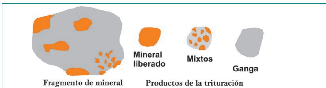
Figura 100. Tipos de partículas producto de la molienda de mineral. Fuente: traducido y modificado por los autores de (Wills, 2006).
