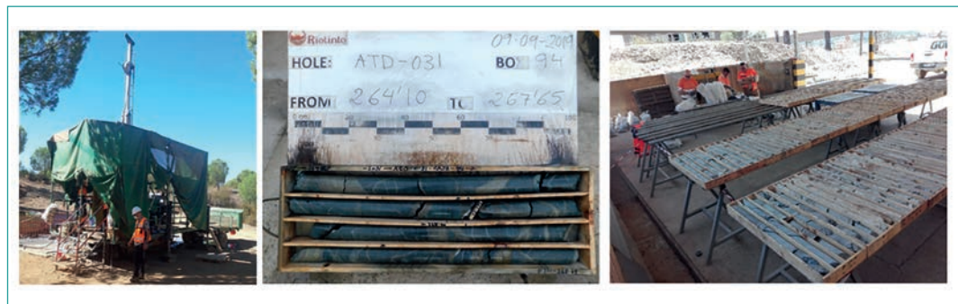
Figura 11. Equipo de perforación con recuperación de testigo (izda.) y registro fotográfico de cajas de testigos de sondeos de exploración (centro) y tareas de descripción y muestreo (dcha.). Fuente: (Martínez, 2019) y (Ore Reserves Engineering, 2022).
