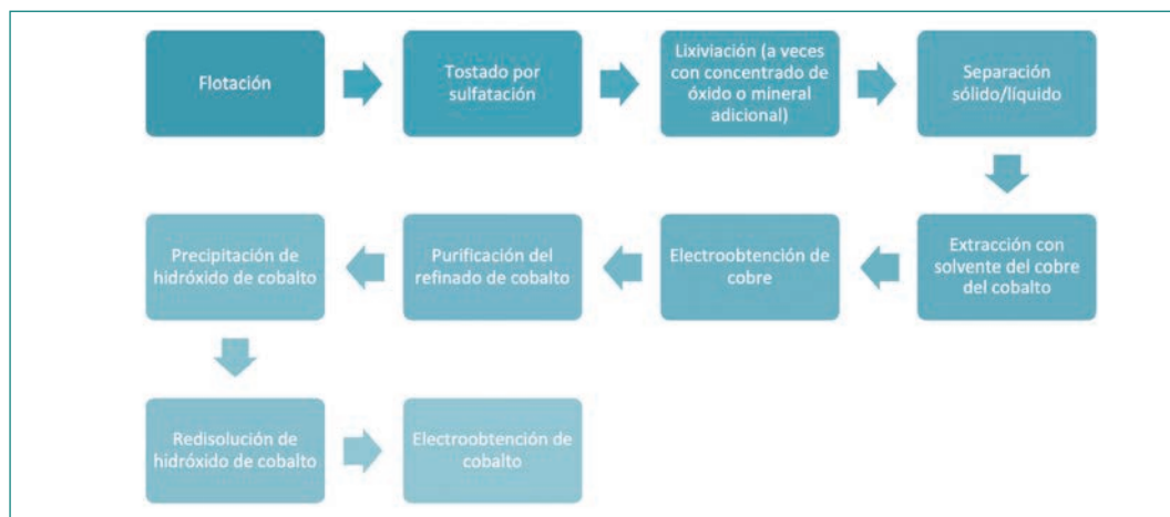
Figura 94. Fases de la metalurgia del cobalto. Fuente: elaboración propia de los autores.
