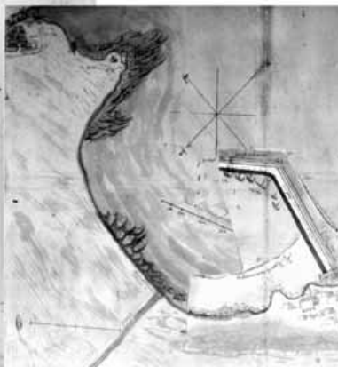
7.5. Planimetría con doble escala en «baras»: Anónimo (1614), Bahía de Cádiz con Rota y su muelle (1135 × 830 mm). Un recortable superpone el diseño del nuevo muelle (A.G.S., M.P. y D. XXI-47).
